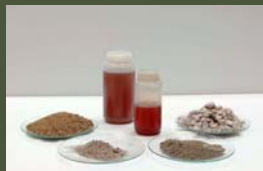
Fini agregat-piljesak, leteci pepeo, cement, krupni agregat, aerant, ubrzivač vezanja, ...
